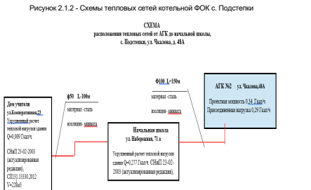
Рисунки 2.1.3 - Схемы тепловых сетей от АГК №2 до начальной школы с. Подстепки
