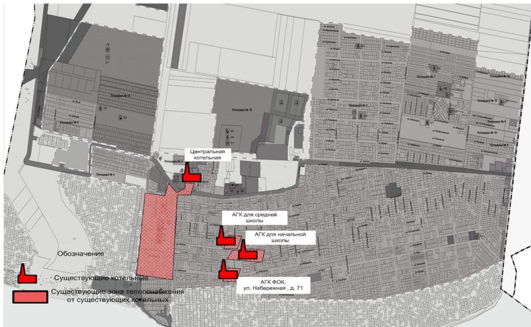
Рисунок 1.4.1 - Существующие зоны централизованного теплоснабжения с. Подстепки.
